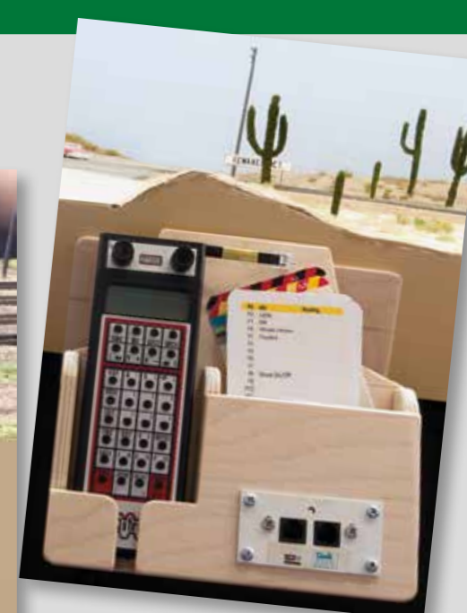
Otro ejemplo: la caja de conexiones y de mando, en este caso, un Digitrax. [AGP]
