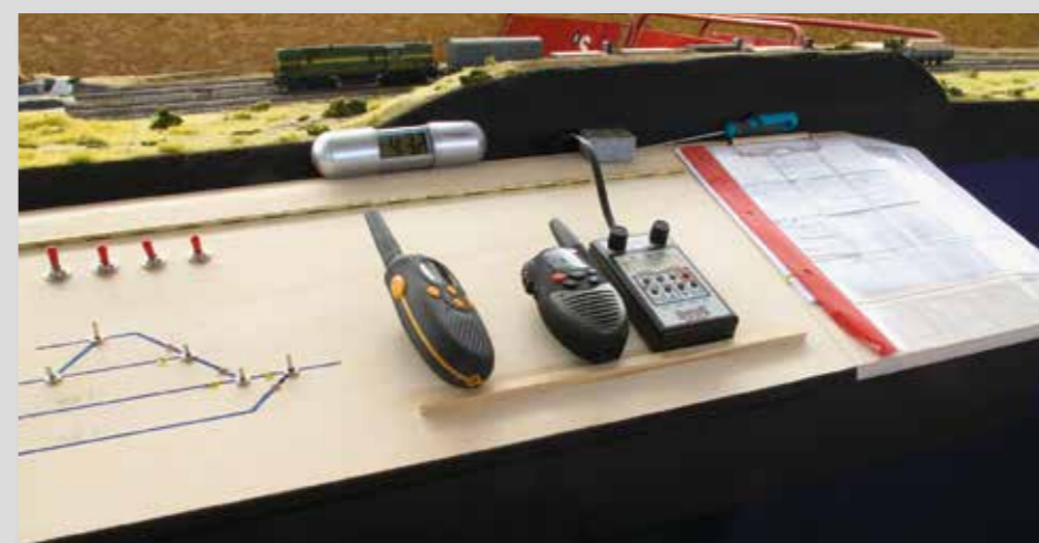
La versatilidad de la LocoNet permite conectar directamente, cualquier componente que cumpla la normativa DCC como ha sido el caso de los mandos Digitrax en algún Encuentro de Maquetren. [AGP]
