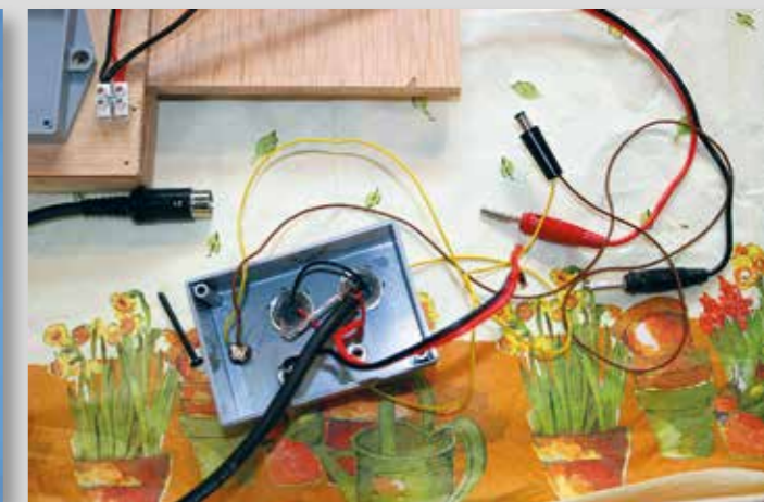
En Delicias pudimos ver las primeras pruebas de las cajas de conexiones, el nuevo cableado y conectores. En las fotos falta el Bus LocoNet porque no va fijado a los módulos. [AGP]
